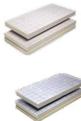
Si presenta sotto forma di pannelli rigidi da installare su tetti (piani o inclinati) e pavimenti (sotto il massetto). La conduttività termica dei pannelli è compresa tra 0,020 W/(m.K) e 0,027 W/(m.K).
